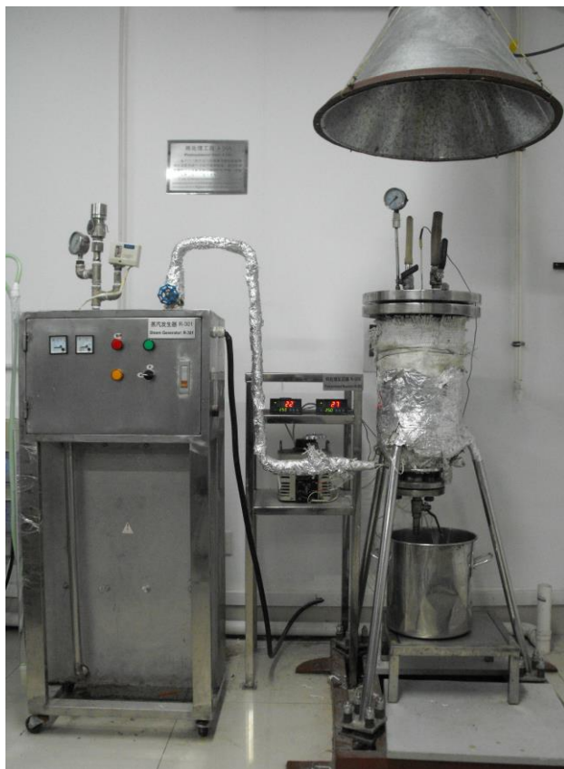
图 2.1 高温稀酸预处理反应器
